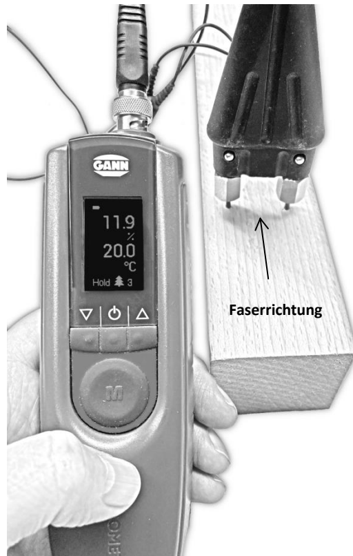
Abbildung 13-1: Holzfeuchtemessung – quer zur Faserrichtung
