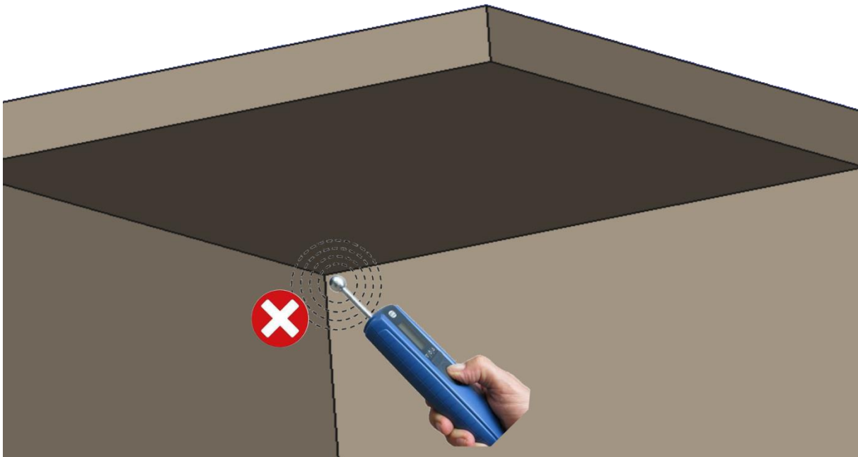
Abbildung 9-6: Falsche Anwendung im Eck-/Winkelbereich
