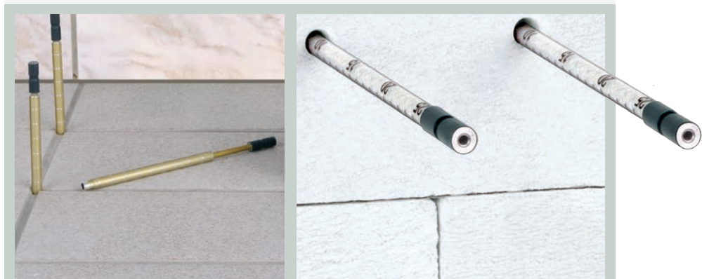
DETAIL Beide Elektrodenpaare sind mit Skalen im Ein-Zentimeter-Raster versehen
