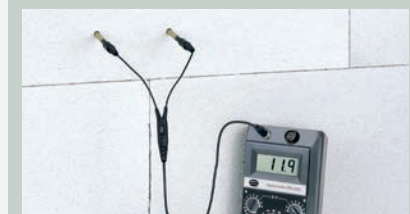
ANWENDUNG Messung mit einem Tiefen-Messelektrodenpaar M 21-250
