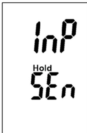
Ist der TF-Stick nicht (korrekt) eingesteckt erscheint bei *langem* (>2 Sekunden) Drücken der Mess-Taste die Anzeige „InP SEn“!
