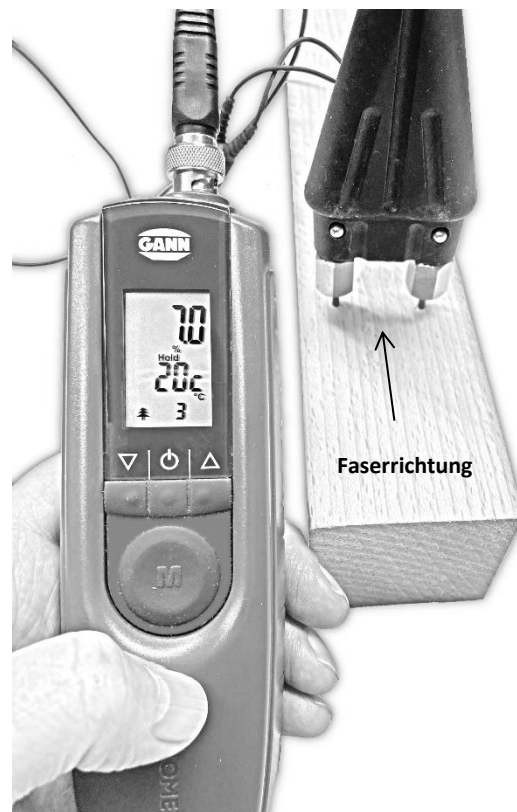
Abbildung 7-1: Holzfeuchtemessung – quer zur Faserrichtung
