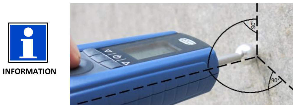
Abbildung 9-3: Messung möglichst senkrecht zur Messfläche
