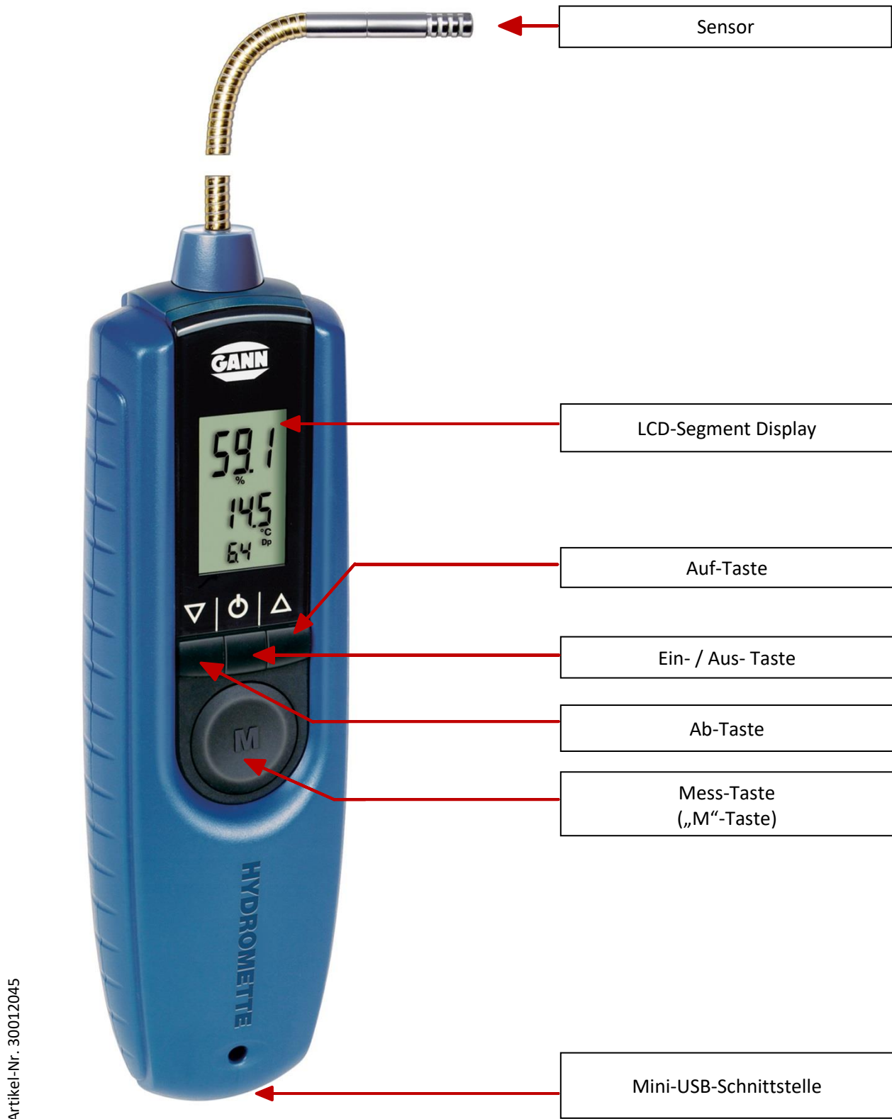
Abbildung 5-1: Ansicht der Hydromette BL Compact RH-T
