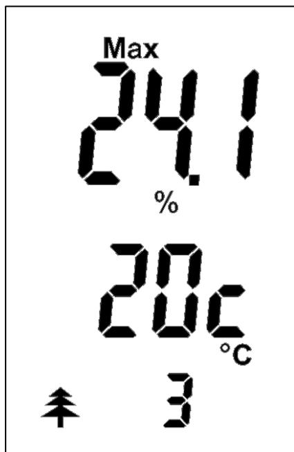
Abbildung 5-10: Maximalwert-Anzeige
