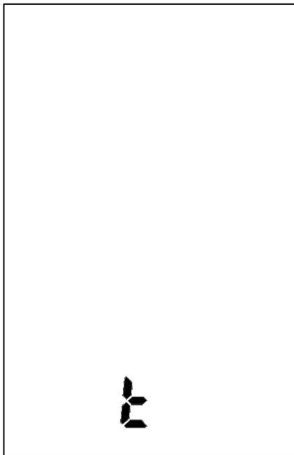
Um die Temperatureinstellung vornehmen zu können, muss das Gerät eingeschaltet sein und sich im Haupt-Messmodus befinden. Durch anschließendes einmaliges Drücken der „Ab“-Taste gelangen Sie zur Materialeinstellung. Soll nun die Einstellung für die Temperaturmessung geändert werden, muss die „M“-Taste *kurz (< 1 Sekunde)* gedrückt werden.
