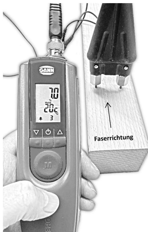
Abbildung 9-1: Holzfeuchtemessung – quer zur Faserrichtung
