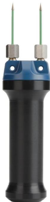
Die Einstech-Elektrode M 19 besteht aus schlagfestem Kunststoff und ist für Messungen von fertig verputzten Wärmedämmverbundsystemen (z.B. Holzfaserdämmstoffe) geeignet.
