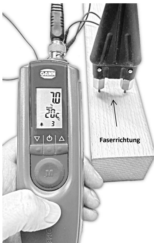
Abbildung 7-1: Holzfeuchtemessung – quer zur Faserrichtung
