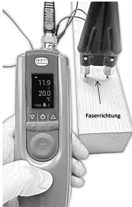
Abbildung 13-1: Holzfeuchtemessung – quer zur Faserrichtung
