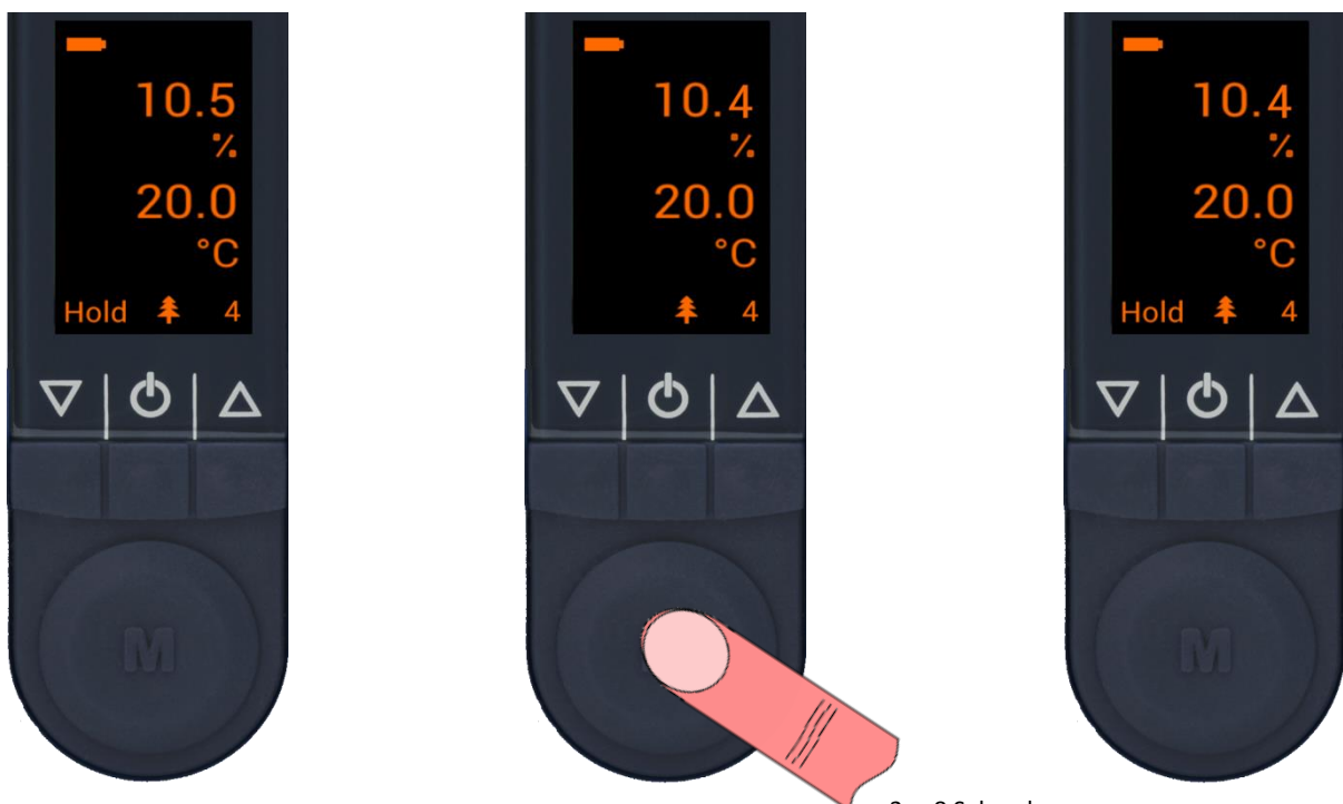
Abbildung 8-2: Messvorgang der Basismessung
