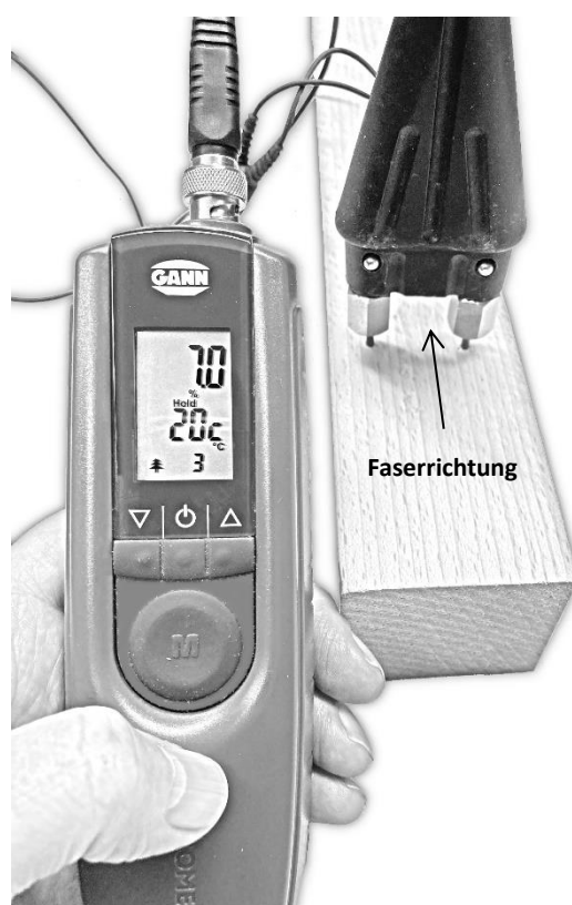
Abbildung 7-1: Holzfeuchtemessung – quer zur Faserrichtung
