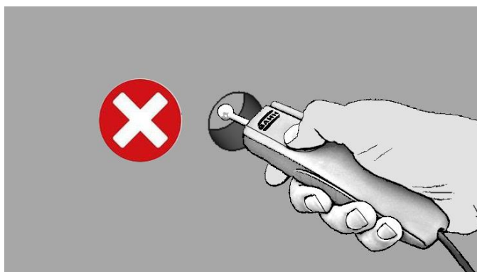
Abbildung 13-4: Falsche Anwendung - Messung im Bohrloch
